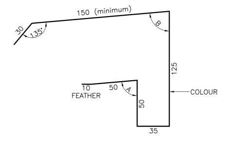
NOTE USE THIS FLASHING IF 100mm FASCIA FACE IS REQUIRED TO FIX G.P. GUTTER BRACKET
